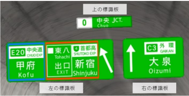
図10 改善案2の分岐1標識における標識板の区別
