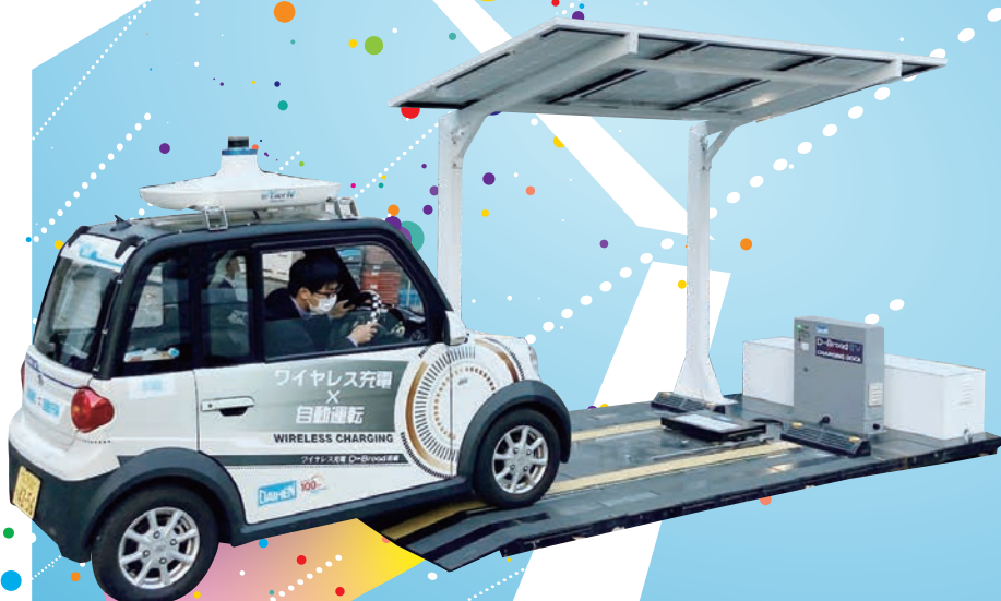
BE 演習実証：小型EV&太陽光 & ワイヤレス給電システム
