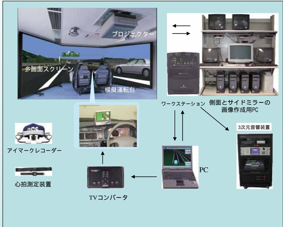
ドライビング・シミュレータとビデオ解析システムを組み合わせることで、交通現象分析の範囲が拡大します。
